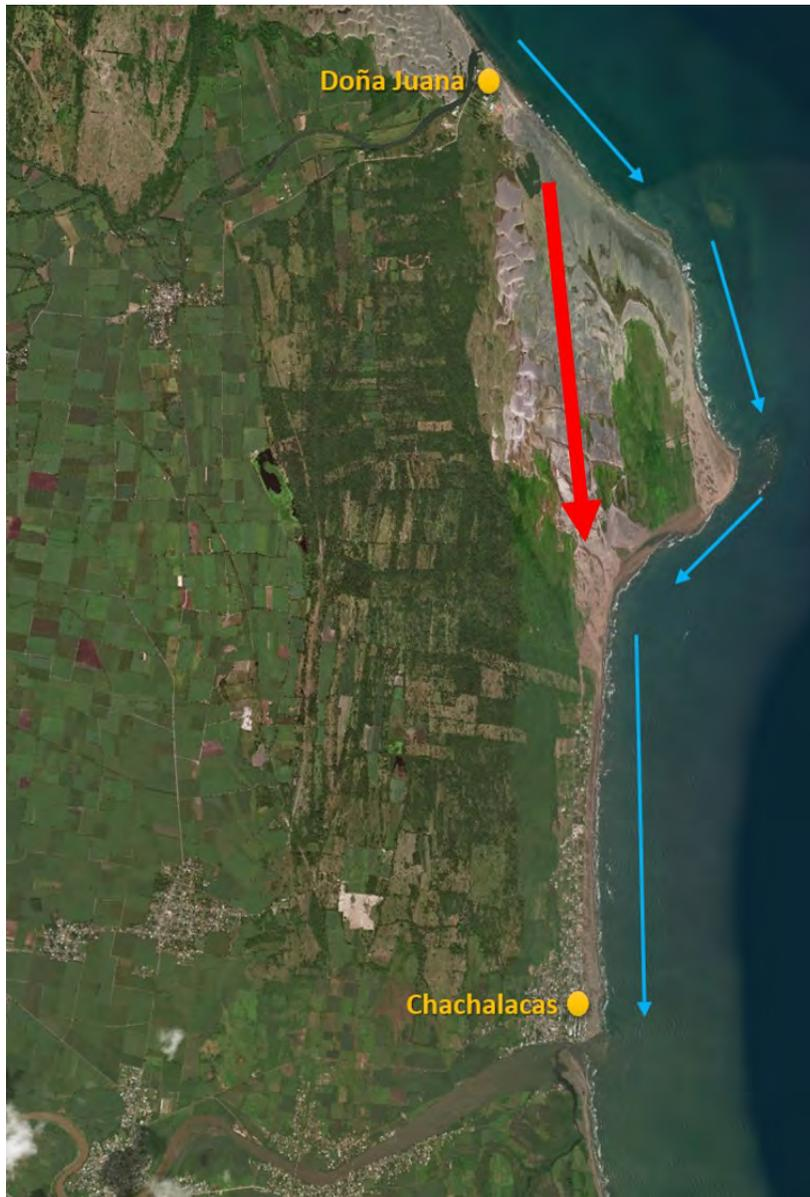
Figura 6. Factores que determinan el movimiento de la arena en la playa y dunas del municipio. Las flechas azules indican esquemáticamente la dirección de las corrientes por oleaje y la roja la del viento.
